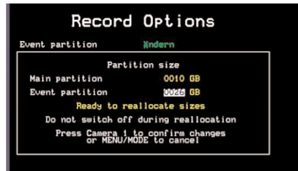
**Bild als Beispiel:** verfügbare Festplattengrößen von 80 - 320 GB; mit Taste ↑ oder ↓ gewünschten Wert einstellen, mit Kamerataste 1 bestätigen und ca. 2 Minuten warten. Gerät führt einen Neustart durch.
