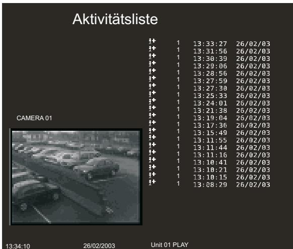
Benutzen Sie die Tasten **↑ ↓**, um die Markierung in der Liste nach oben oder nach unten zu bewegen. Ein Bild der Aktivität wird automatisch angezeigt, sobald die Markierung bewegt wird. Von dieser Anzeige aus können Sie die folgenden Funktionen aktivieren:
